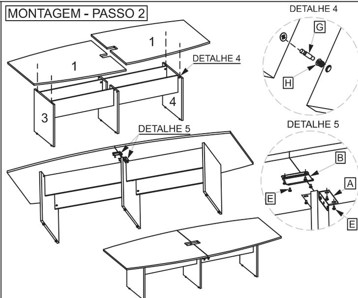
NA SEQUENCIA PARA FACILITAR A FIXAÇÃO DO TAMPO (1), COM A ESTRUTURA EM PÉ, FAÇA O ENCAIXE DO TAMPO (1) NOS PÉS PAINÉIS LATERIAS (3,4) CONFORME INDICA DETALHE 4. APÓS O TAMPO (1) POSICIONADO, FAÇA O TRAVAMENTO COM AS CHAPAS DE CONEXÃO COMO INDICA O DETALHE 5.
